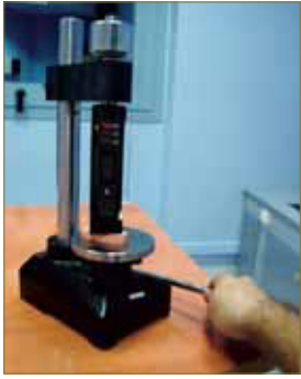
Figura 12: Maniobra de medición de la dureza. Figura 13: Penetrador del durómetro.
