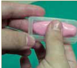
Figura 9: La silicona, catalizando, se introduce en la probeta, sobre la cual termina de reticular.
