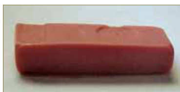
Figura 17: La silicona A no resiste la presión del durómetro en la lectura de los 5 y 10 minutos.
