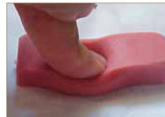
Figura 2: Palpación directa como método empírico para conocer la dureza de la silicona.
