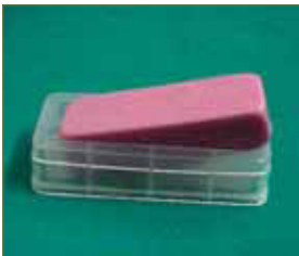
Figura 10: Extraemos el positivo de silicona a los 5 minutos.
