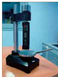
Figura 5: Durómetro Shore A acoplado a un banco de prueba.
