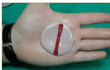
Figura 19: El catalizador en pasta propicia una dureza menor con respecto al catalizador líquido.
