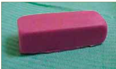
Figura 11: Superficie lisa del positivo de silicona para una correcta medición de su dureza.
