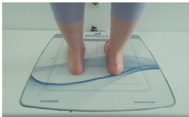
Figura 3. Toma de presiones plantares con el sujeto mirando de espaldas.
